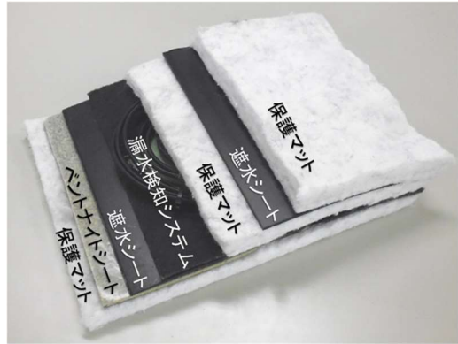
遮水工の実物写真 総厚は3.75cmになります
