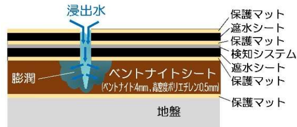
ベントナイトシートが漏水を防ぐ概念図
